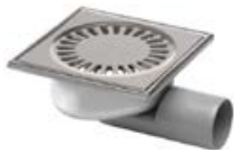
Aquaberg Blücher Compact RVS vloerput met gepolijste bovenzijde 147x147mm | ABS onder,- / zijuitloop = 50mm | waterslot = 30mm | 182150050 | artikel 2300308
